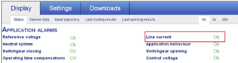
Figura 45: Alarme instantâneo de corrente de alta tensão (web IHM)
