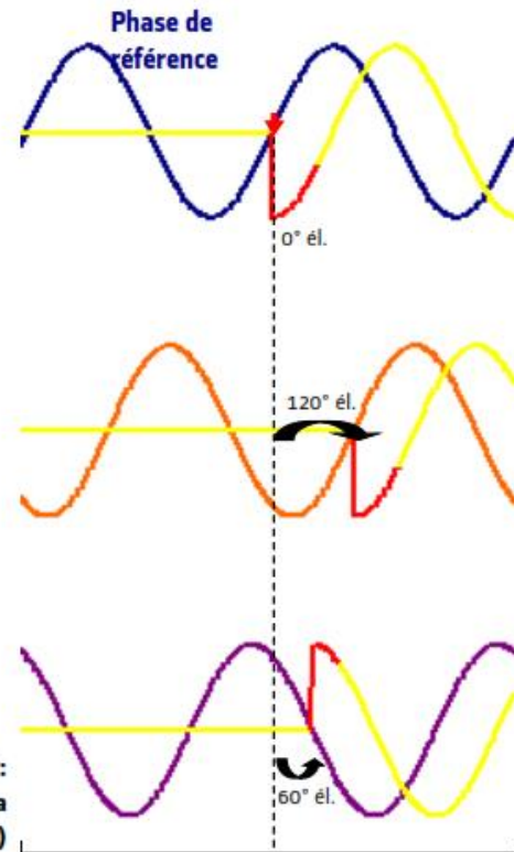
Figura 107: Sequência de manobra de religamento sobre linha não compensada alimentada por TP indutivo (neutro aterrado)
