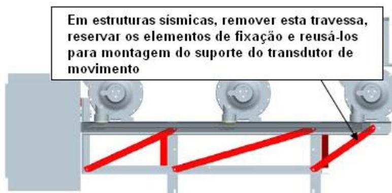
Figura 1: Estrutura Sísmica
