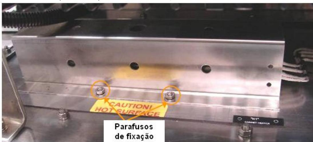
**Figura 14: Remoção da Cobertura**
