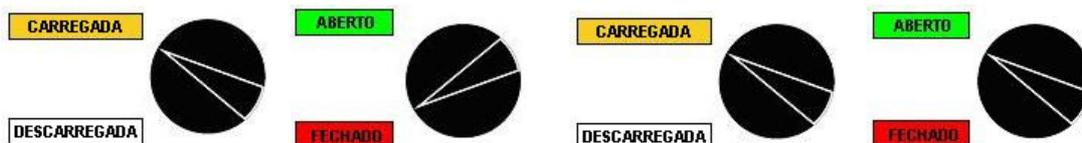
a) Mecanismo na posição fechada, com a mola de fechamento carregada (o motor deve estar desconectado).
