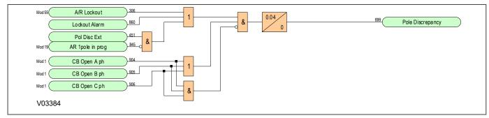
Figure 216: Pole Discrepancy Logic Diagram (Module 62)
