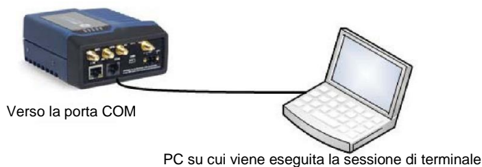
Figura 6. Impostazione per la porta seriale di configurazione del PC (è necessario un adattatore RJ-45)
