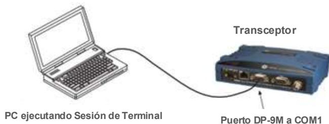
**Figure 5. Ajustes para la configuración del PC**
